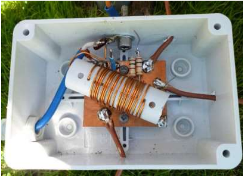
Figure 7 : Vue interne du boîtier d'adaptation.
