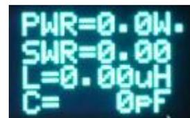
Un accord automatique s'active si le ROS dépasse la valeur programmée (1.3/1) et que la puissance est suffisante mais inférieure à la puissance maximale.
