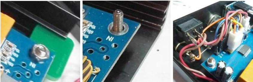
Ce montage est acceptable mais la carte n'est retenue horizontalement que par les liaisons sur les embases BNC à l'arrière.
