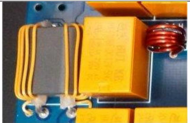
Résultat avant de monter les connecteurs coaxiaux. Les connecteurs SMA livrés ne sont pas pratiques pour la HF et fragiles. On soudera des fils courts entre les prises et les trous de la carte.
