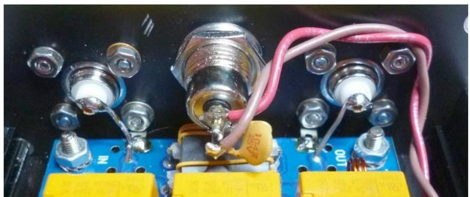
Entre la carte et les embases BNC, j'ai également remplacé les cosses de masse fournies par des cosses plates soudées au plan de masse.
