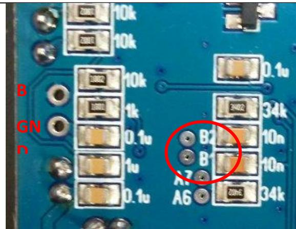
Le raccordement des fils sur B1 (by pass) et B2 (Auto) est peu élégant pour séparer la platine de la façade en cas d'intervention sur le PCB.
