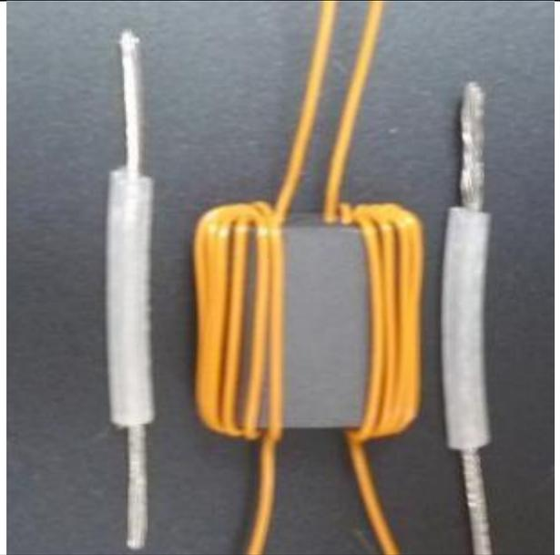
Passer le fil isolé **10 fois au centre** de chaque côté. On doit compter neuf passages à l'extérieur. Dénuder les fils isolés avec précaution car l'isolant colle au fil et il peut se casser
