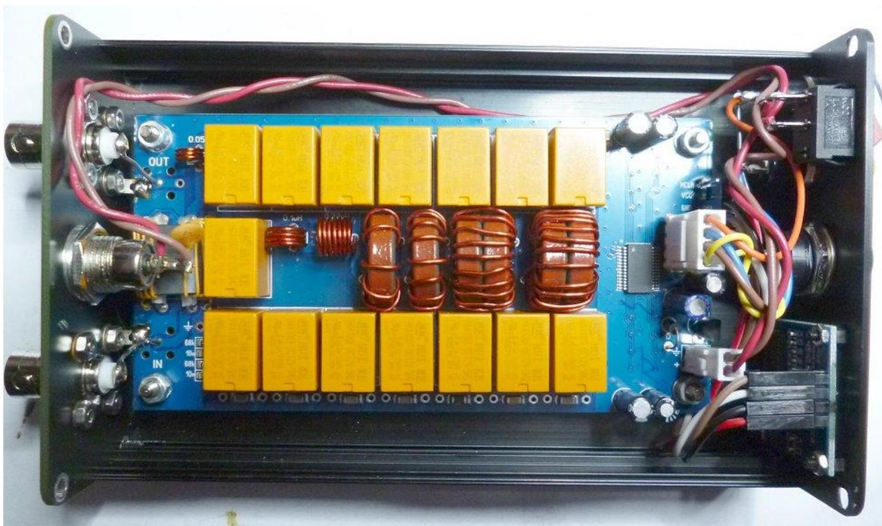
Le fil d'alimentation 12 V part de la carte, puis le + passe par l'interrupteur. La paire de fil longe le flanc du boîtier du côté des relais des inductances (présence de plan de masse) contrairement à l'autre côté qui comporte les capacités d'accord. Avec certains kits sont livrés un module « booster » qui est un convertisseur 5V vers 9V pour alimenter l'appareil par une source 5V USB. Personnellement, je n'adhère pas à cette solution qui peut être source d'interférences.
