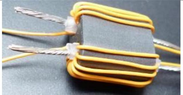
Insérer le coupleur à 1 mm au-dessus du circuit imprimé. Souder le coupleur.
