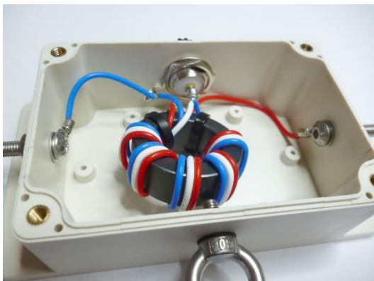
Figure 3 : Réalisation de l'autotransformateur à enroulements couplés.
