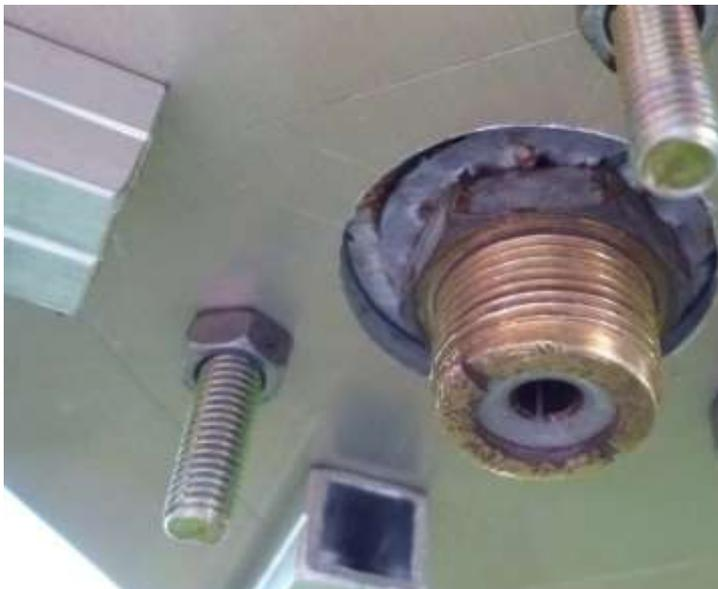
Figure 6 : L'embase de raccordement d'origine en SO239 et la fiche PL n'inspirent pas à une bonne tenue dans le temps et une étanchéité médiocre. On veillera à utiliser une fiche en laiton pour éviter un couple de corrosion galvanique. La fiche sera recouverte de plusieurs tours de ruban adhésif d'étanchéité résistant aux UV du soleil.
