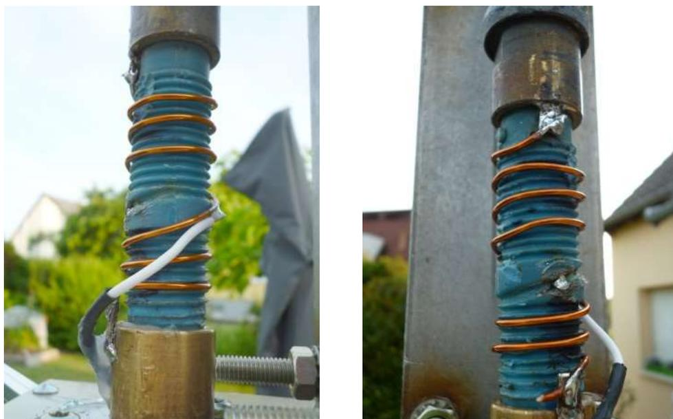
Figure 3 : réalisation finale de la bobine d'adaptation
