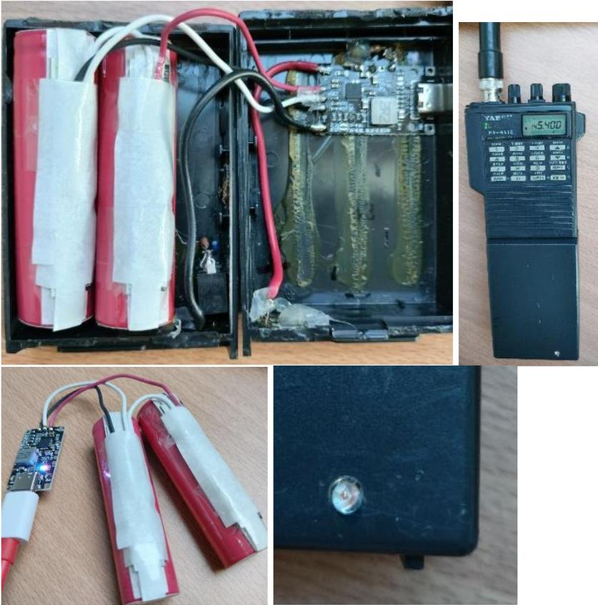
Mettre une mousse néoprène entre le circuit imprimé et la batterie.
