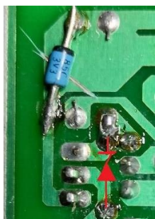
Figure 11 : Modification sous Q1 pour 12,5V.
