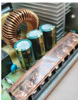
Figure 4 : Filtrage de la sortie 48 V.
