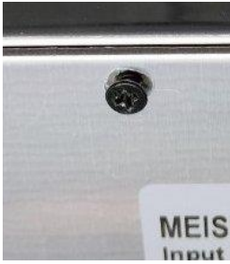
Figure 19 : Ajout d'une vis de contact au boîtier.
