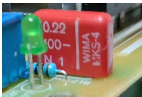
Figure 16 : La capacité Y de sortie est remplacée par 0,22 \mu\text{F} .
