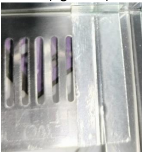
Figure 18 : Application d'un film d'aluminium dans le couvercle.
