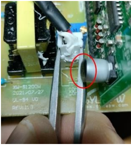
Figure 7 : Extraction du connecteur du ventilateur.
