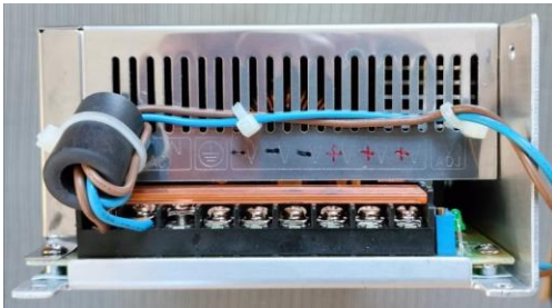
Figure 20 : Ajout d'un tube de ferrite de mode commun à l'entrée 230V.
