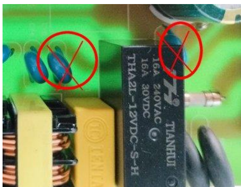
Figure 15 : Capacités Y du filtre secteur à dessouder
