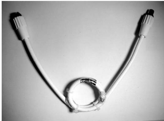
Au cours de l'été, les orages et les effets de la foudre provoquent des dégâts importants aux téléviseurs et souvent irrémédiables aux installations de d'antenne. Le présent dispositif apporte une protection supplémentaire contre les courants de gaine qui circulent sur le câble d'antenne. Ces courants s'écoulent généralement entre l'antenne et la masse châssis du téléviseur. En effet, le téléviseur réalise la jonction entre deux réseaux différents :
