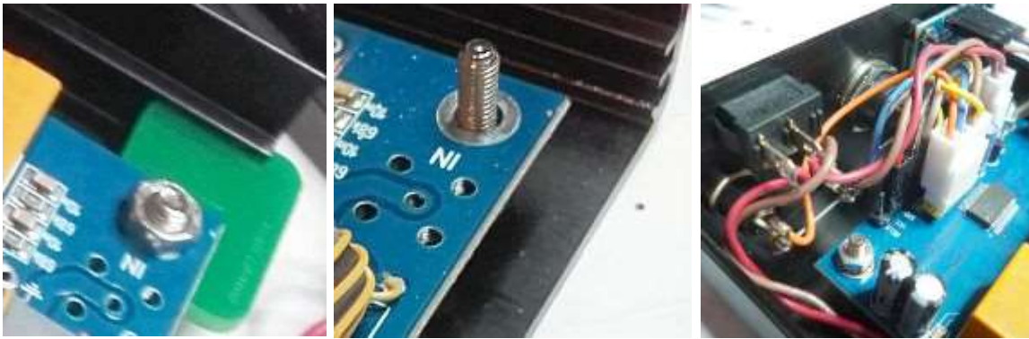
Figures 2a à 2c : Montage dans la boîtier et raccordement avant.
