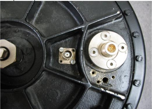
Cavité passe-bas : Percer une BNC sur la tangente au cercle de la prise N, au même rayon que le N.
