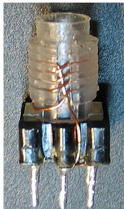
L'étage d'entrée nécessite un réalignement de T01 et T02 au générateur HF à 145 MHz : se baser sur le maximum de déviation du S-mètre.
