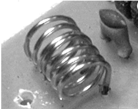
Figure 3 Détail de la self d'entrée L1-L2
