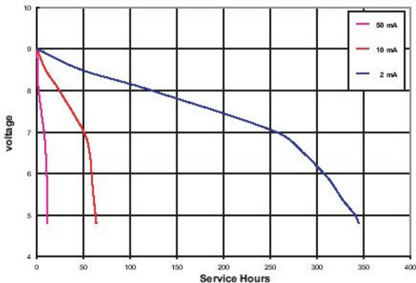
Figure 7 : Courbe de décharge d'une pile 9V alcaline à courant constant.
