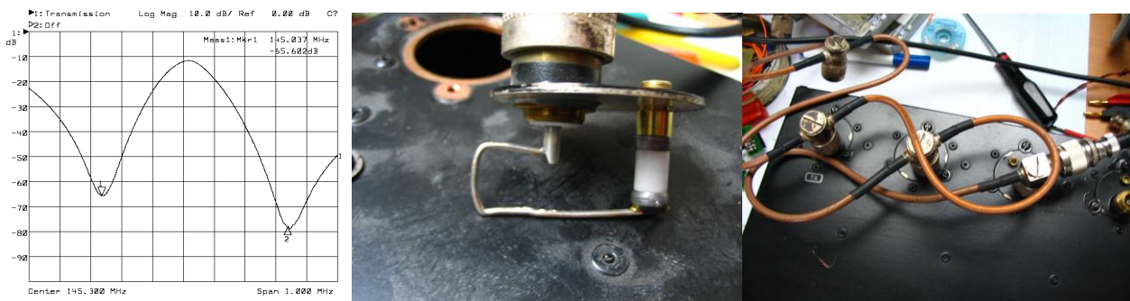
Figure 1 : Atténuation entre les voies Rx et Tx et aspect d'une boucle de couplage
