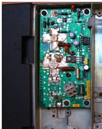
Figure 4 : Vue du PA 200 MHz modifié
