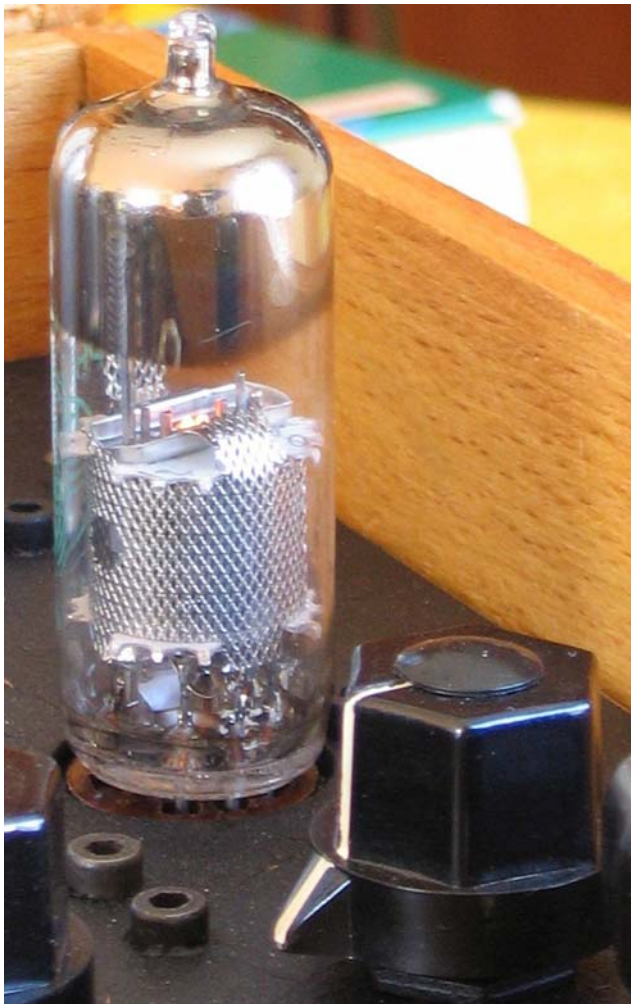
Figure 7 : La penthode à pente variable EF85 et le potentiomètre de gain RF.
