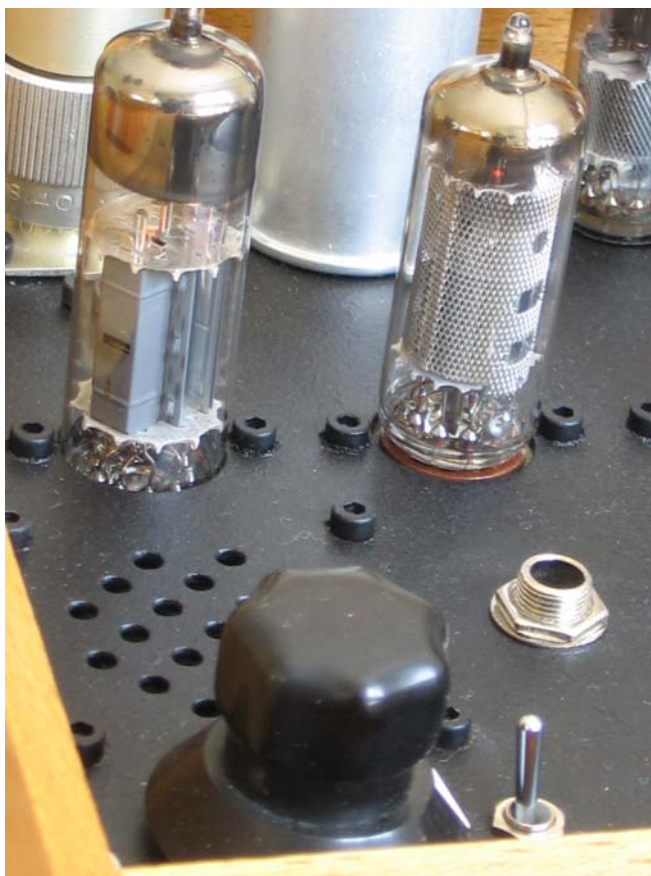
Figure 13 : L' ECL82 est encastré pour être au même niveau que les autres tubes.
