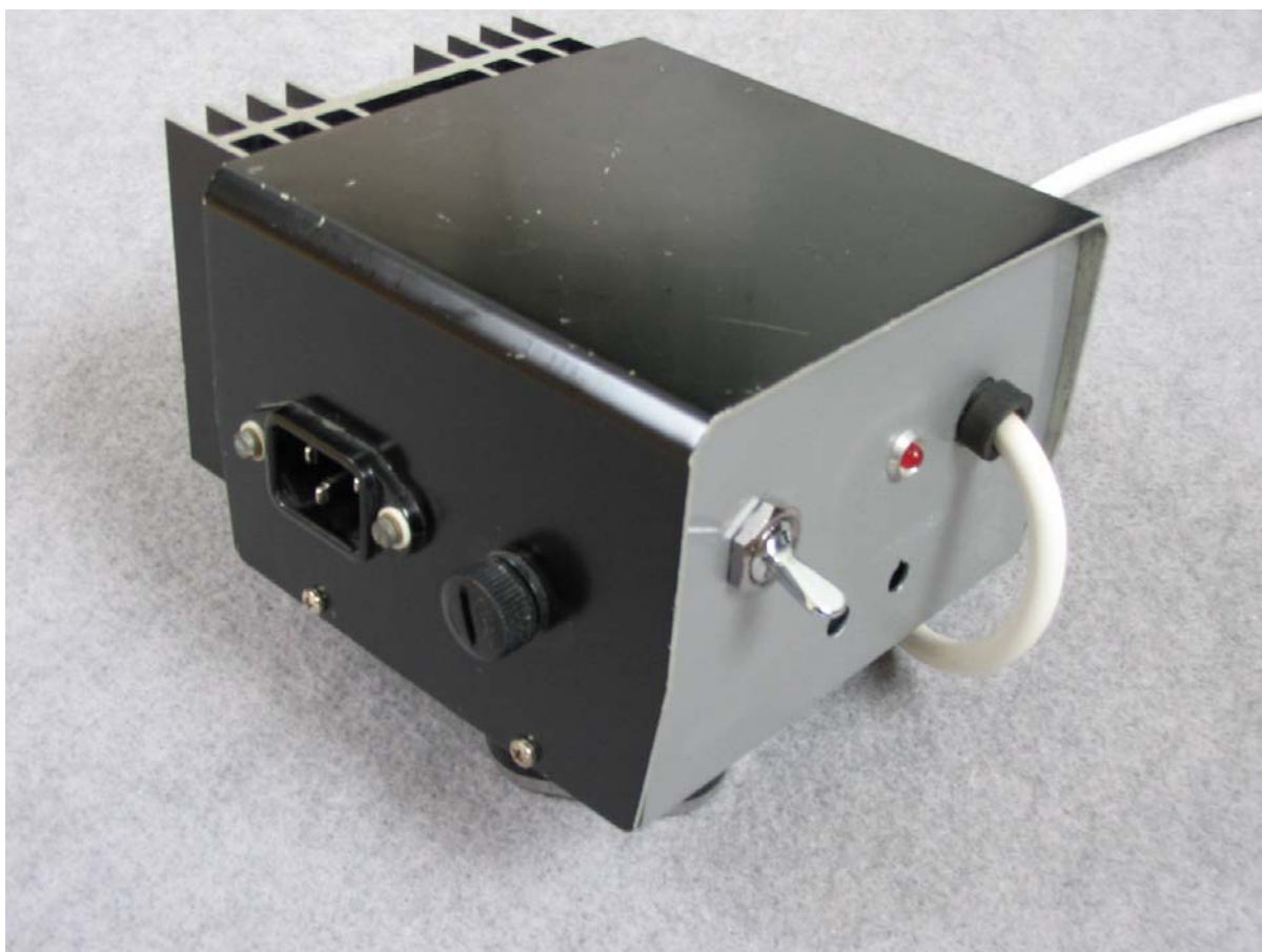
Figure 17 : L'alimentation haute-tension et chauffage déportée du récepteur.
