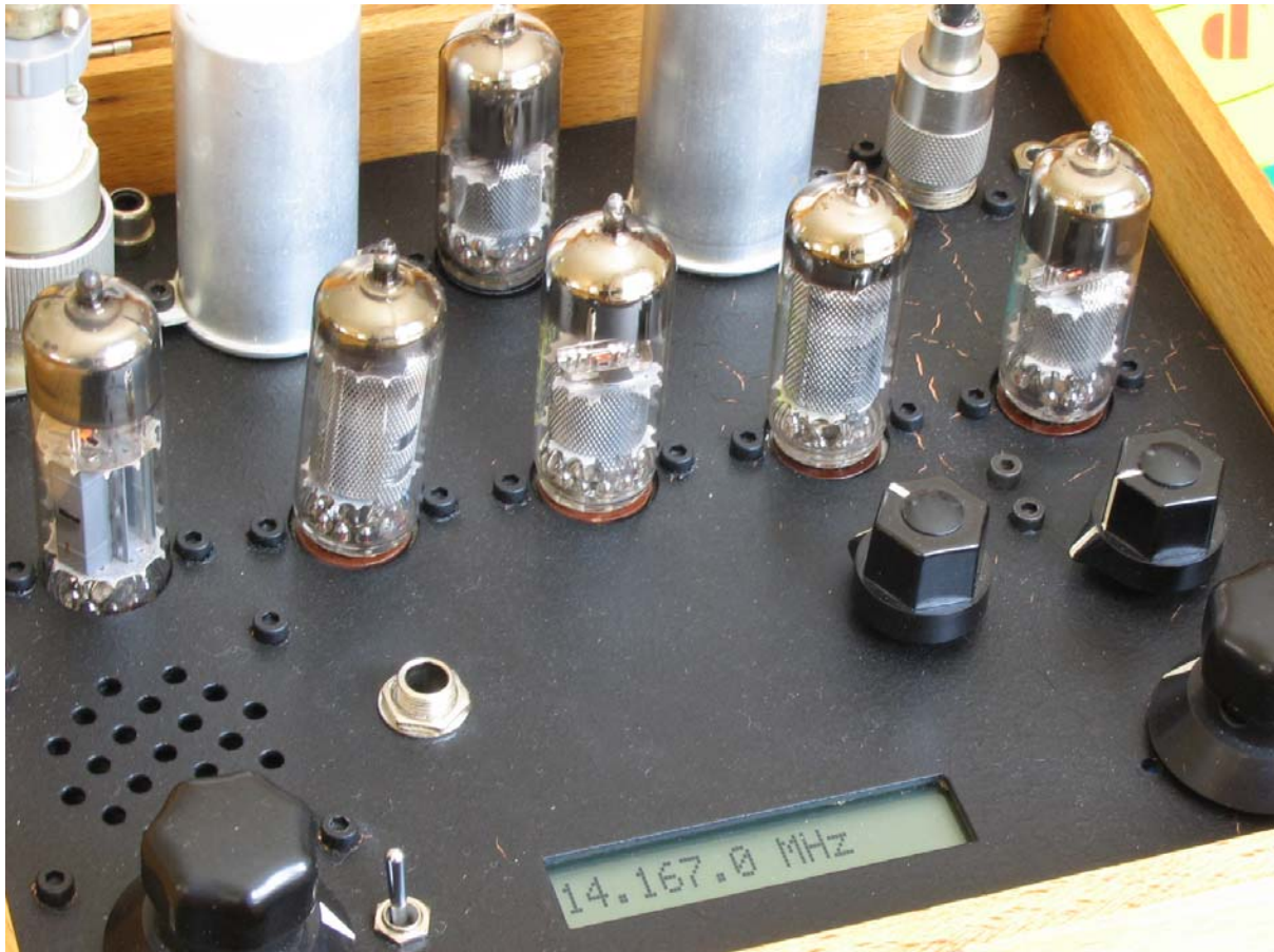
Figure 2 : ... de l'antenne jusqu'au haut-parleur, le signal transite par les tubes !
