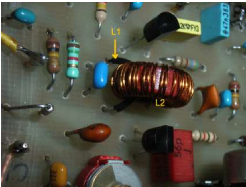
Figure 4 : Détail de la self L2 et de la spire de couplage L1.
