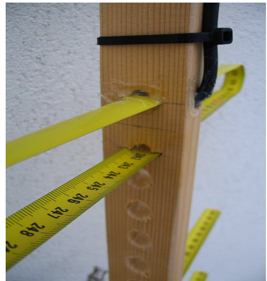
Figure 7 : Détail du passage pour le câble coaxial
