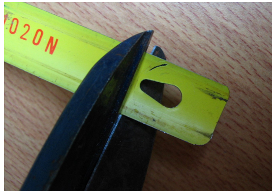
Figure 2 : Découpe à la cisaille à tôle
