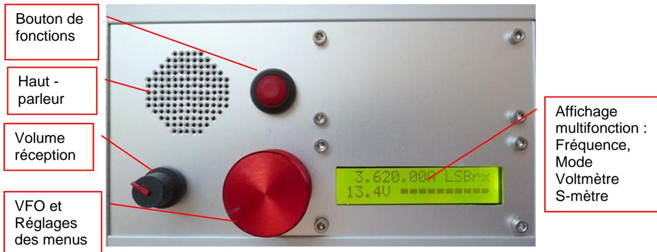
Le bouton du VFO est un potentiomètre 10 tours sans cran comme un condensateur variable ; il permet à la fois un réglage fin (par pas de 50Hz) sur une plage de 50 kHz et le changement de bande entre 1 et 30 MHz.
