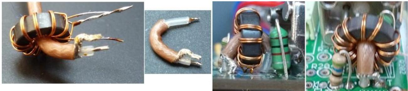
Le montage du tore de couplage est facilité si les fils du bobinage sont plus longs, préformer le coax avec des pinces à becs fins. Le fil F qui va dans le trou central doit sortir du centre du tore côté L202.
