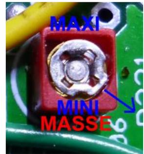
L'opération consiste à régler les condensateurs ajustables CV301 et CV302 pour le maximum de gain.
