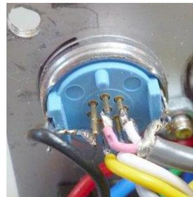
La tresse du câble blindé est soudée au châssis de la prise.
