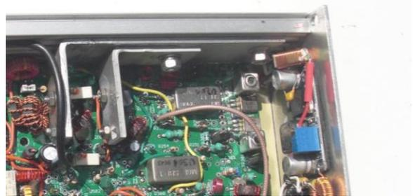
La difficulté est la mise en place des tores TR 103 et TR104 : ils sont un peu coincés par l'équerre de Q100 et Q101 et se retrouvent un peu de biais, mais en gardant des fils assez longs, on y arrive !
