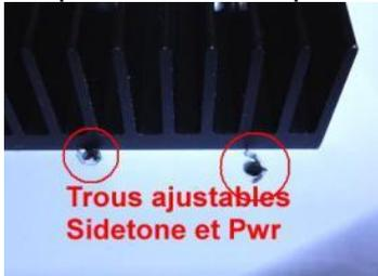
Centrer le radiateur contre la face externe du fond, et pointer les 4 trous sur le radiateur avec un foret de 2,5 mm en rotation. **Attention laisser le passage des profilés qui prennent 3 mm sur la largeur de la façade ! (ou assembler le boîtier avant), prévoir 3,5 mm pour garantir un peu de jeu. S'arranger pour les perçages passent entre les ailettes (écart 22,9 et 12,7 mm). Vérifier à deux fois !**
