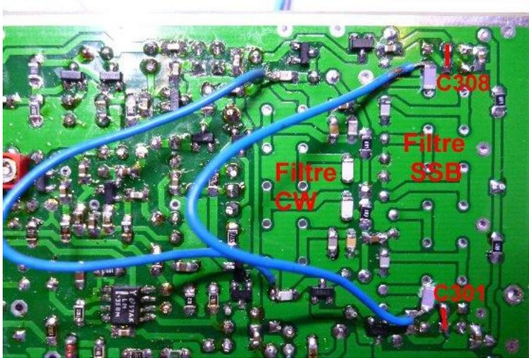
Souder un fil de 20 cm au trou noté P2D3 (sous la zone de rencontre des straps U, V et W). Ce fil commandera la commutation des filtres par le VFOduino :
