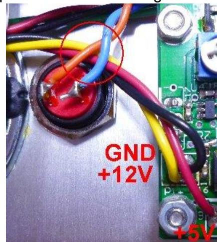
Comme les fils précédent ce faisceau passe au-dessus du coax de la sortie panoramique. Passer les fils derrière quelques-uns de ceux qui vont aux prises DIN pour aller dans la zone de l'interrupteur à glissière.
