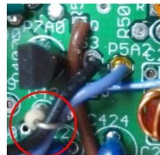
SWRmètre du retour (REV). Il se situe à l'arrière du jack J2 entre la transistor Q407 et le tore L207. Passer le fil dans la boucle de la résistance R436 pour éviter qu'il ne s'arrache.
