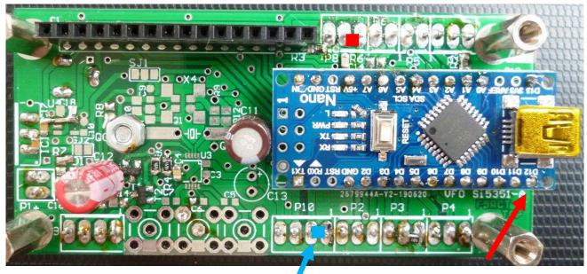
Au niveau du connecteur P10 relier les broches 1 et 2 par un pont de soudure : 1 et 2 sont à GND
