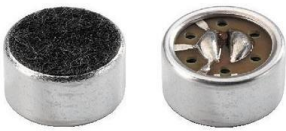
Figure 6 : Le microphone « électret ».
