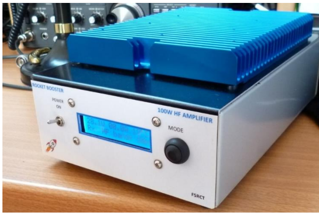
Figure 2 : Rocket booster : le PA 100 W conçu pour le Rocket.
