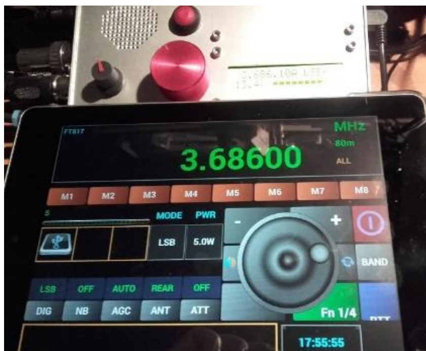
Figure 7 : Le pilotage du VFO avec une tablette et l'application Pocket Rx Tx permet l'accès direct en fréquence et aux bandes amateurs.
