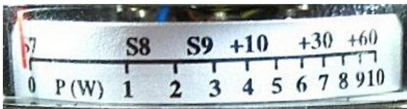
Figure 6 : Cadran du S-mètre et indicateur de puissance du Squirrelly.
