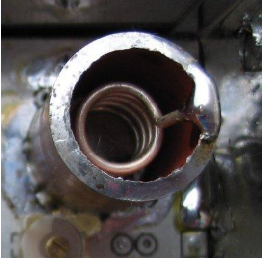
Figure 1 : Détail de la cavité coaxiale de la self d'entrée L15.
