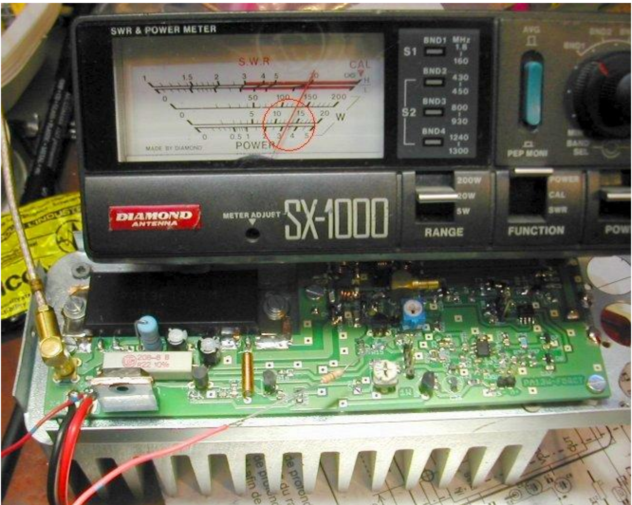
PA de F6CMB en cours de test.
